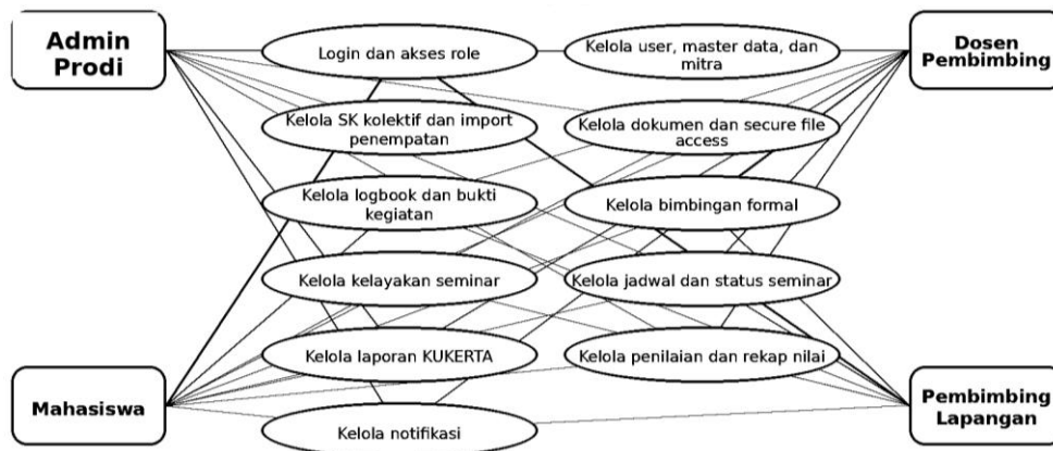
Gambar 2. Use Case Diagram Umum Sistem Informasi Magang
